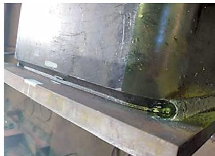
▲写真3 人工欠陥(タングステン鋼)を埋め込みしたコラムの開先部(製作角鹿鉄工)
