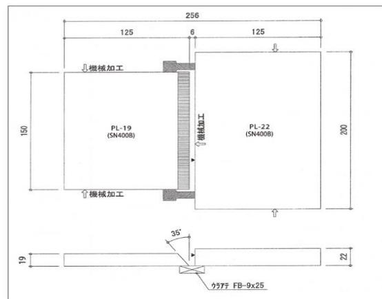
「固形エンドタブ技能検定」は、溶接技能者に対して溶接部の始末端の施工の重要性を座学で、また実際に固形タブの技量試験を実施し、試験判定を行い、固形エンドタブ技量を有する溶接技能者であるかどうかの証明を行います。技量認定試験の実施に際して、独自に「固形エンドタブ溶接技能者技量検定試験要領」「同工場溶接試験基準」「同工場試験運用規程」「同工場溶接試験判定基準」を定め公正さを担保しています。試験は板厚 22mm と 19mm の SN400B 材を使用し、裏当て金有の異幅の板のレ形突合せ溶接で行います。判定は第三者による外観検査、超音波探傷検査、端部のマクロ試験を実施し、厳格な総合判定を行い、合格者には有効期限 3 年間の顔写真入りの資格証が交付されます。
